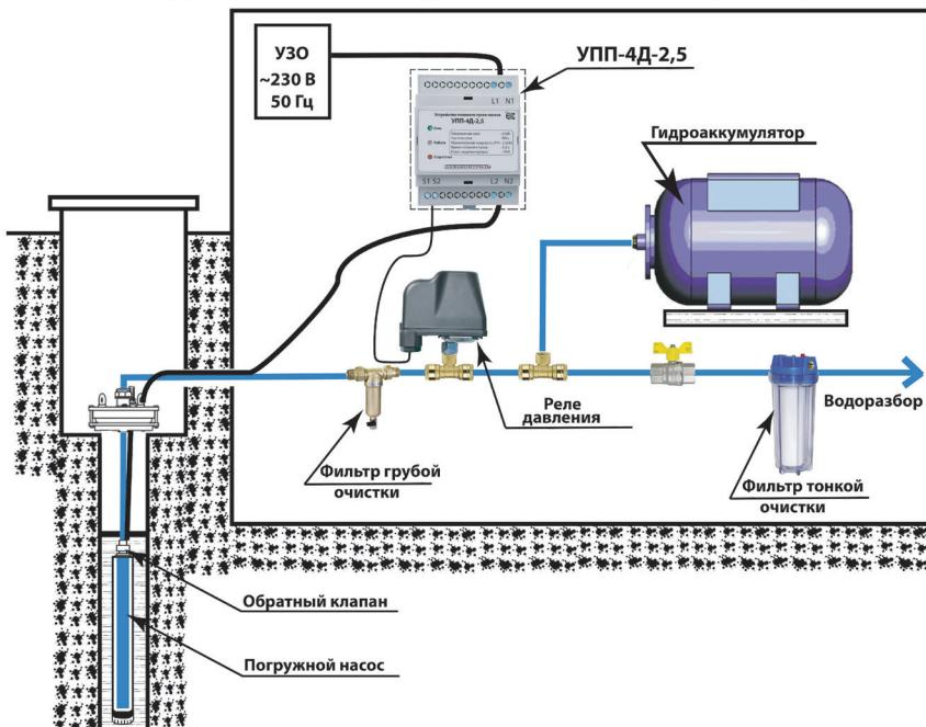
**Пример подключения приборов УПП-4Д-2,5 "Акваконтроль" с электронными реле давления серии РДЭ или РДС через адаптер планого пуска АПП**
