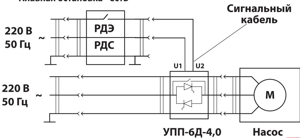
**Пример подключения приборов УПП-4Д-2,5 "Акваконтроль" с погружным насосом и реле давления типа РД-5/(РДМ).**
